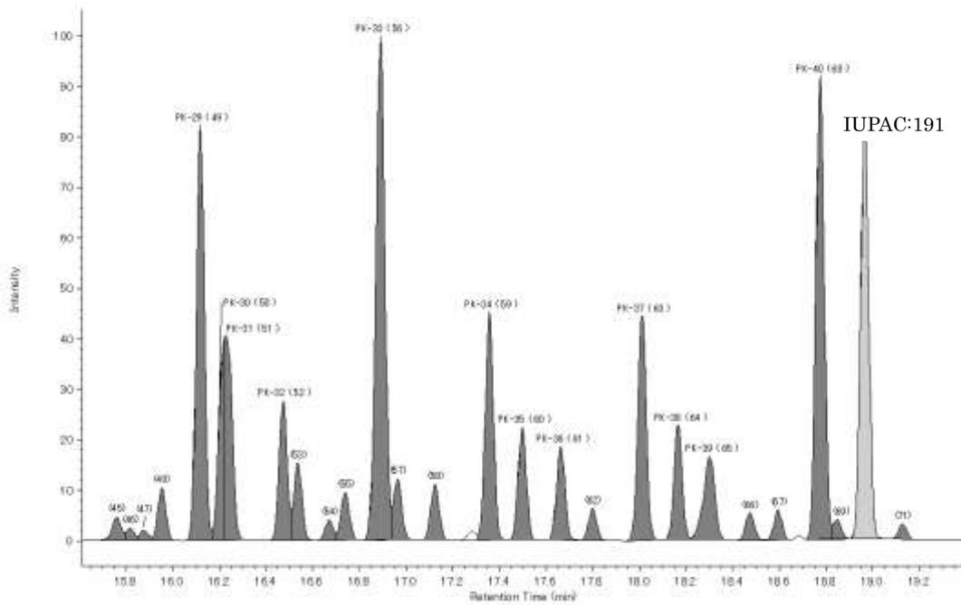
付図 2.5.1.5 標準溶液のクロマトグラム拡大(例) (絶縁油で PCB5.0mg/kg 相当)
