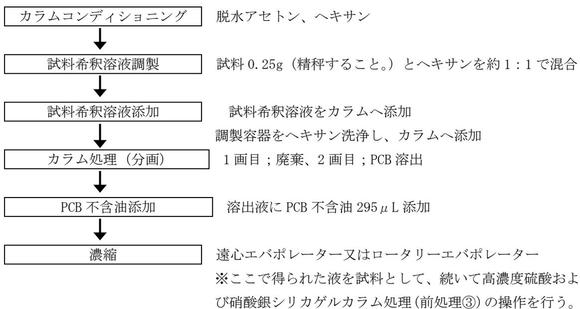
図 3. 3. 1. 3 DMSO 分配カラム処理 (前処理②) の操作フロー
