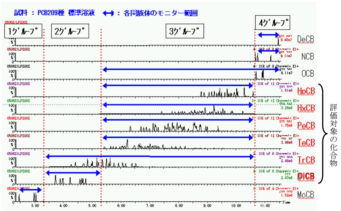
付図 2.2.1.1 測定時のクロマトグラフィー例 (PCB209 種標準溶液)
