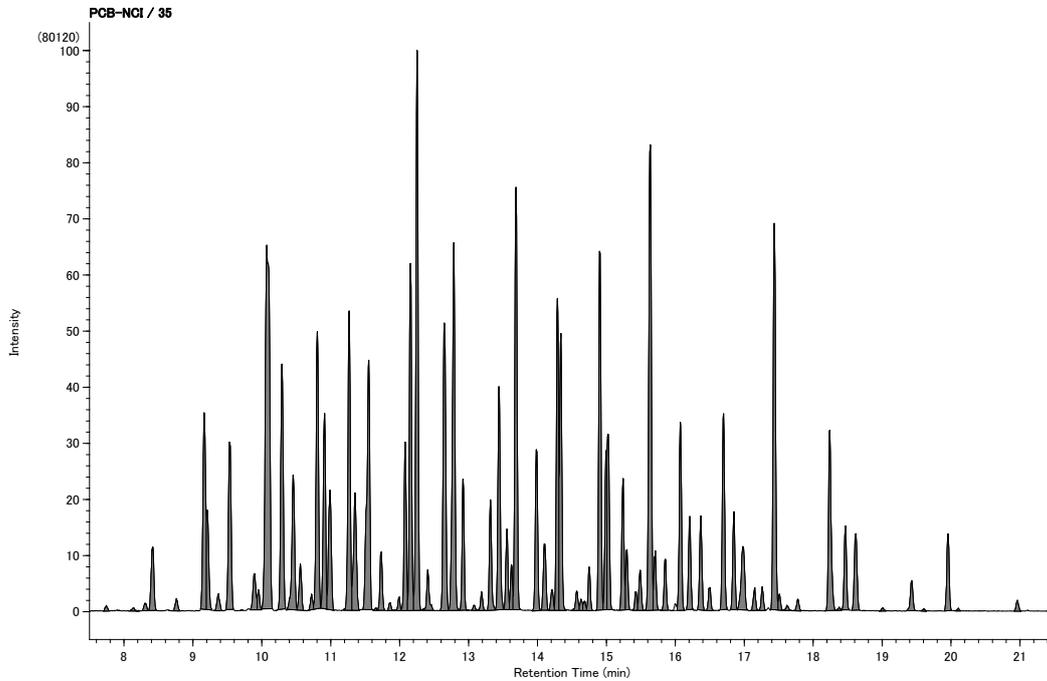
付図 3. 2. 1. 3 標準液のクロマトグラム例 (絶縁油濃度 5.0mg/kg)
