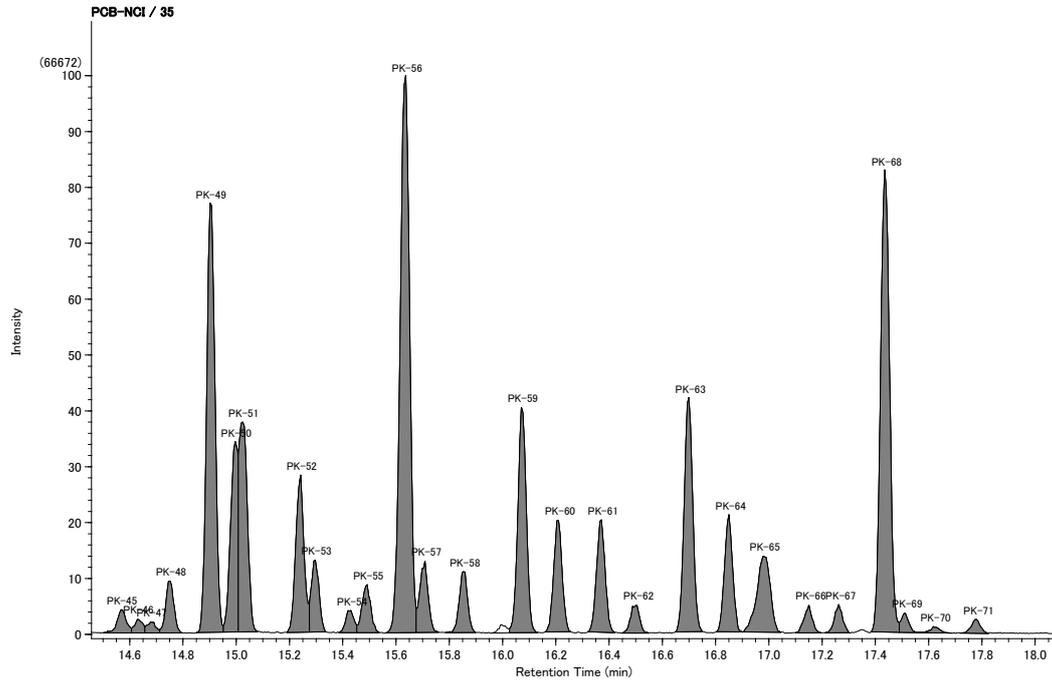
付図 3. 2. 1. 6 標準液のクロマトグラム拡大(例) (絶縁油 5.0mg/kg) 【PK No. 45 から 71】
