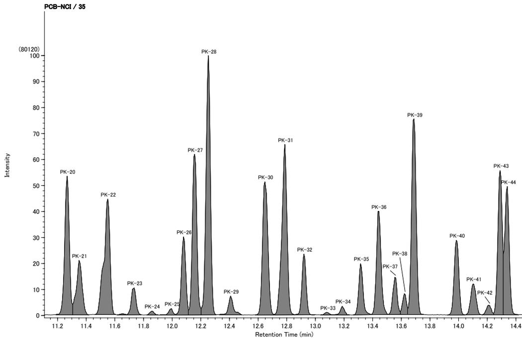
付図 3.2.1.5 標準液のクロマトグラム拡大(例) (絶縁油濃度 5.0mg/kg) 【PK No. 20 から 44】
