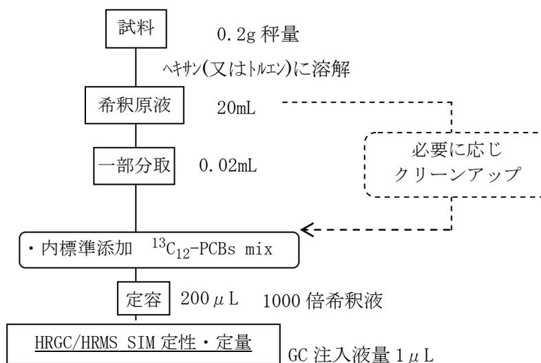
図 2.2.1.1 本測定法の基本フロー図
