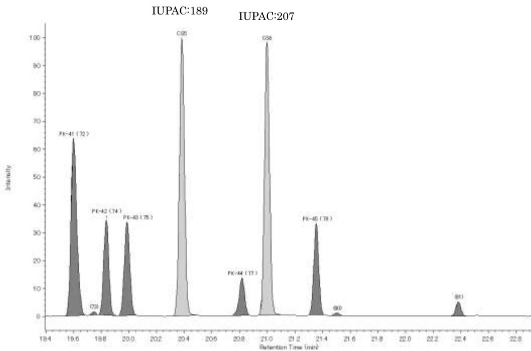
付図 2.5.1.6 標準溶液のクロマトグラム拡大(例) (絶縁油で PCB5.0mg/kg 相当)
