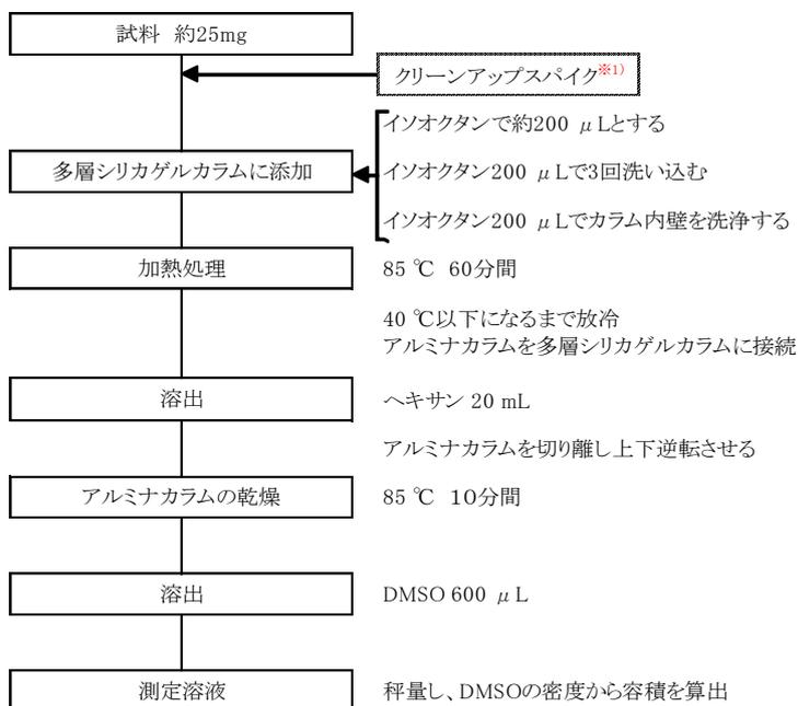
図 3.3.3.1 試料調製のフロー図
