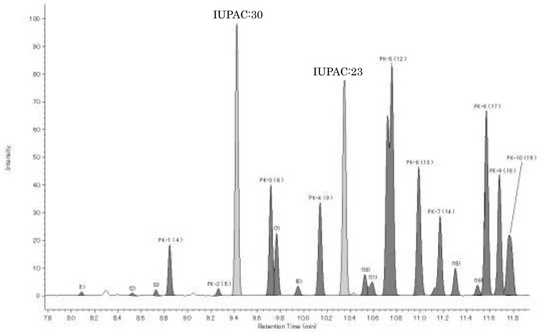
付図 2.5.1.3 標準溶液のクロマトグラム拡大(例) (絶縁油で PCB5.0mg/kg 相当)
