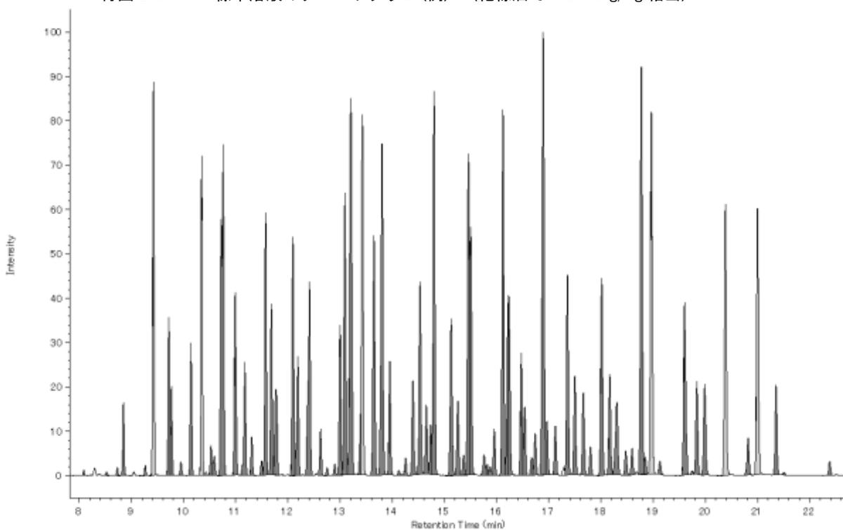
付図 2.5.1.2 標準溶液のクロマトグラム例 (絶縁油で PCB5.0mg/kg 相当)
