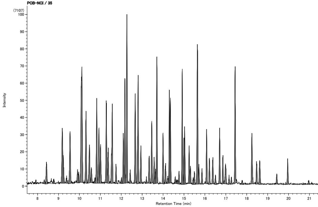
付図 3. 2. 1. 2 標準液のクロマトグラム(例) (絶縁油濃度 0.5mg/kg)
