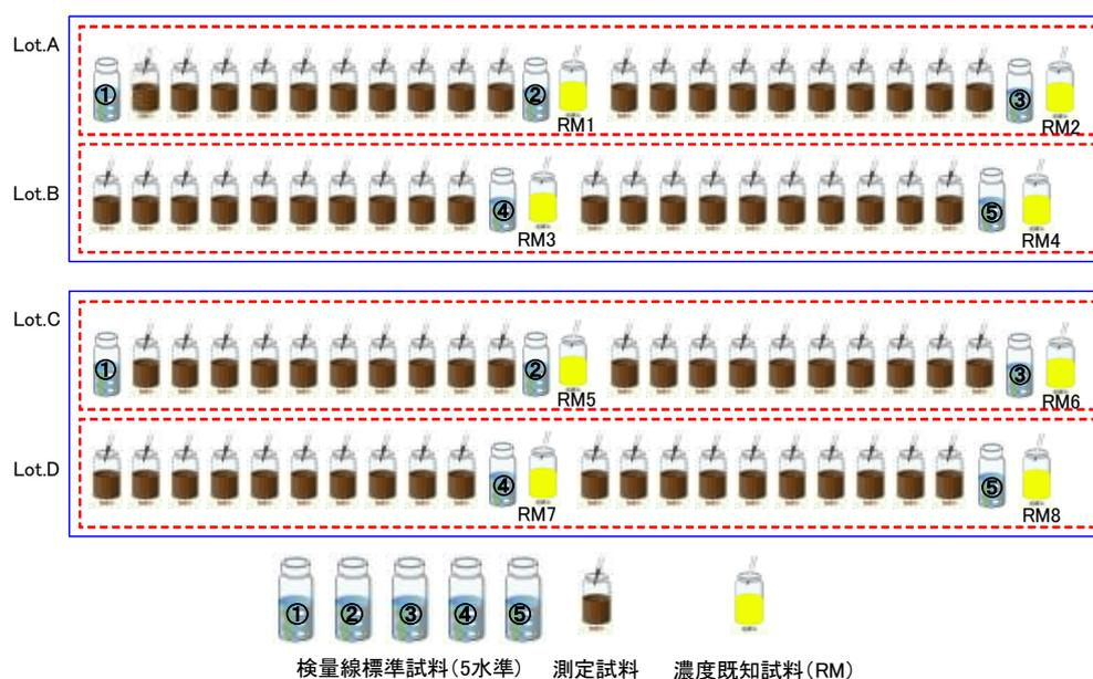
図 3. 3. 2. 7 大量測定時の試料配置例
