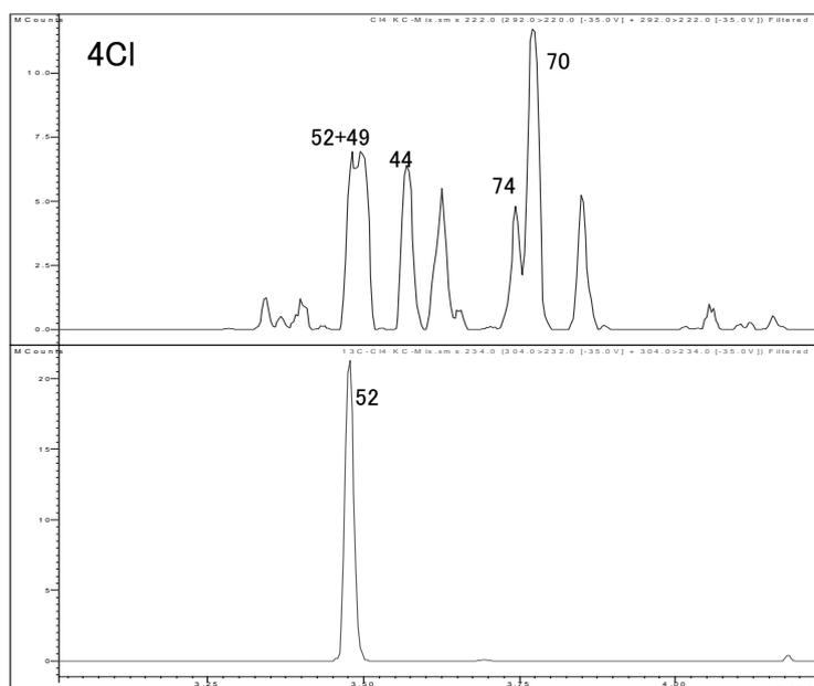
付図 2.3.1.1 GC/MS/MS による各塩素のクロマトグラム
