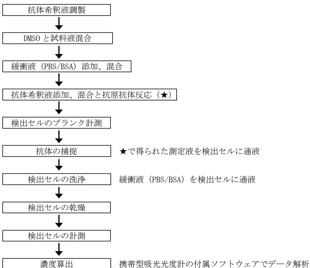
図 3.3.1.9 測定 (イムノアッセイ) の操作フロー
