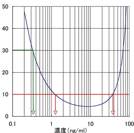
図 3.3.4.4 精度プロファイルの例
