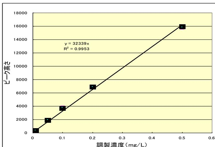
図 3.1.2.5. PCB (KC-mix) 検量線の例
