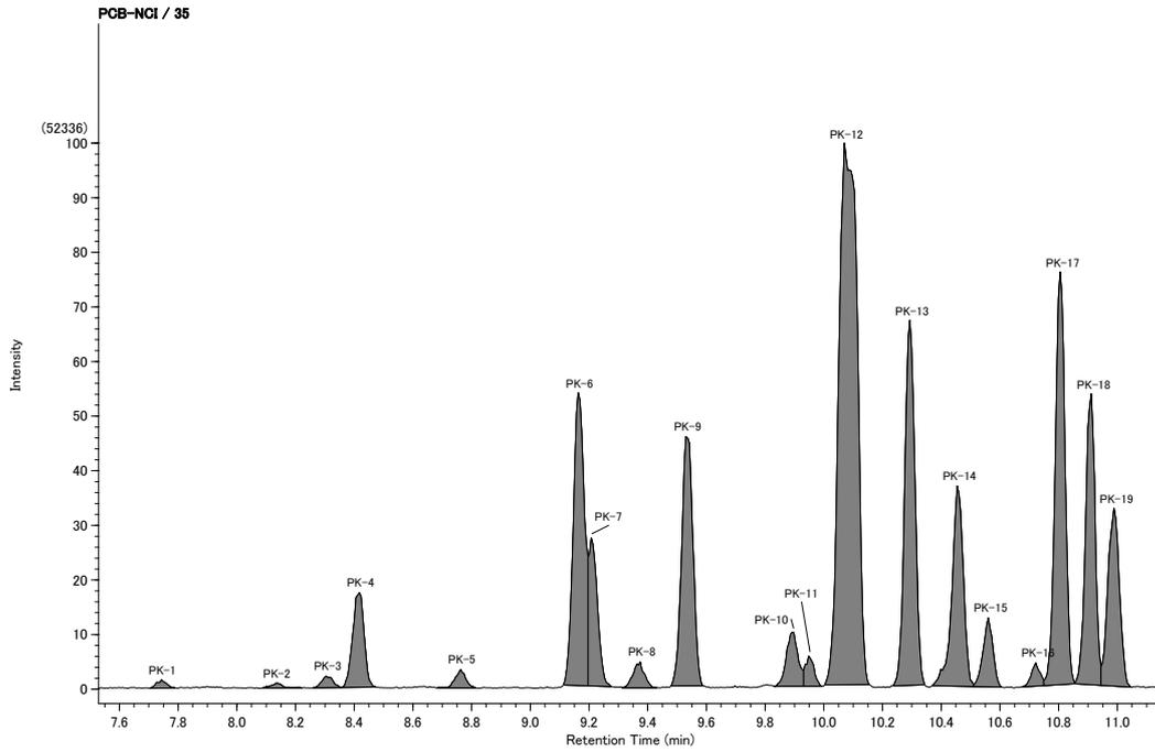
付図 3.2.1.4 標準液のクロマトグラム拡大(例) (絶縁油濃度 5.0mg/kg) 【PK No. 1 から 19】
