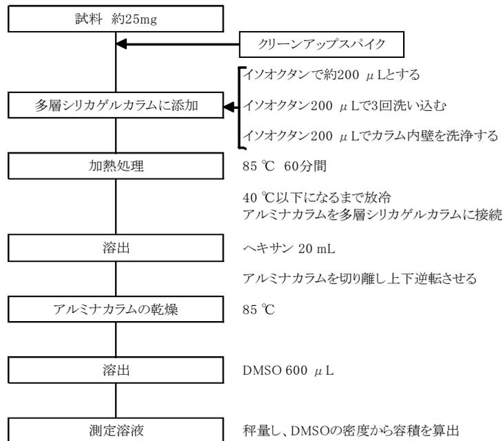
図 2.7.1.1 試料調製のフロー図
