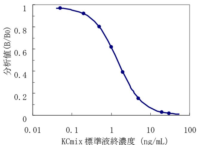
図 2.7.1.3 KCmix 標準液を用いた検量線の例
