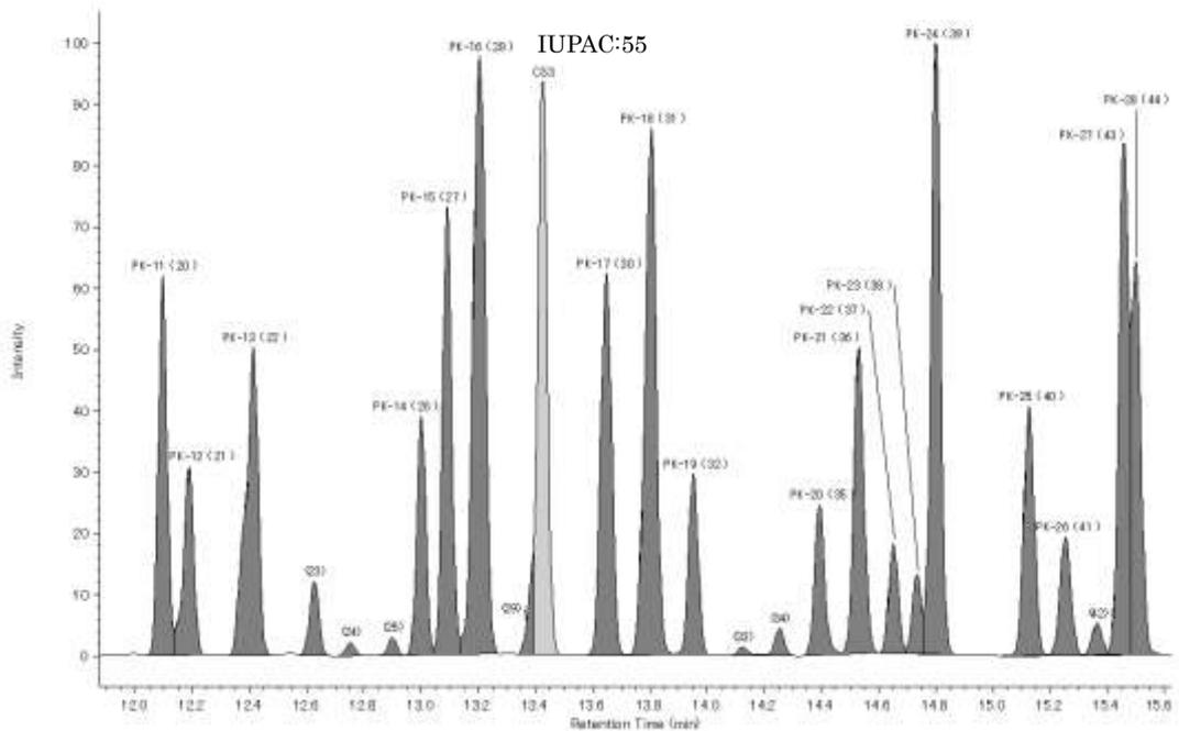
付図 2.5.1.4 標準溶液のクロマトグラム拡大(例) (絶縁油で PCB5.0mg/kg 相当)
