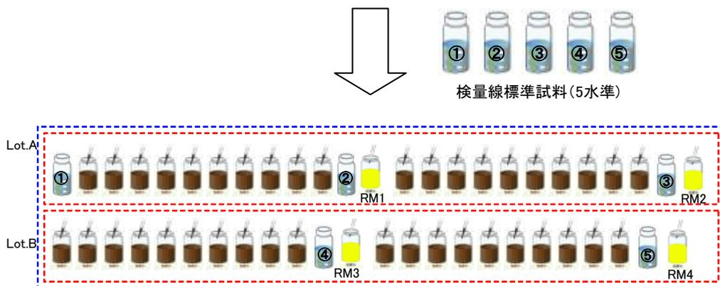
図 3.3.2.6 イムノクロマト反応の配置例
