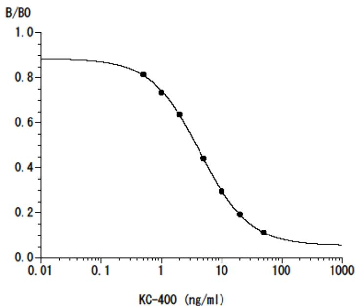
図 3.3.4.3 検量線と 4-パラメーターの式の例
