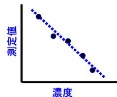
検量線用標準試料の測定値 [A/B] と上記の絶縁油相当の濃度値をプロットし、最小二乗法などにより検量線の傾き係数 a を特定する。
