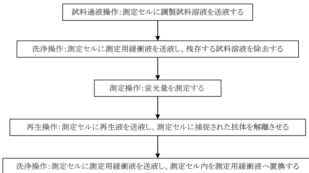
図 2.7.1.4 試料溶液測定のプロロー
