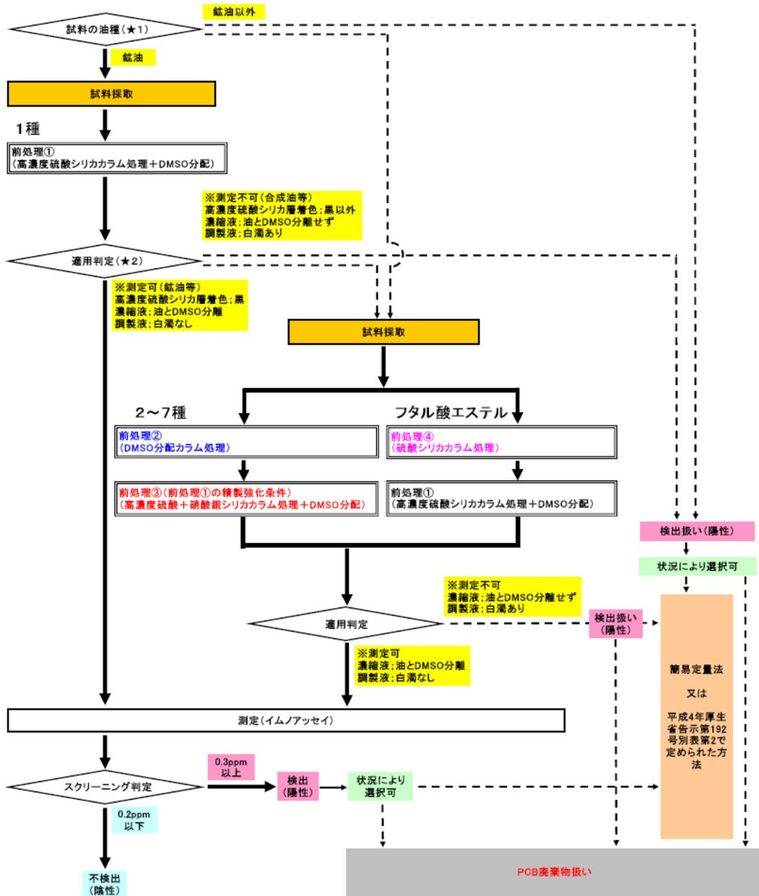
★1 油種確認；GC/FIDで確認する。GC-MS、IR、UV等で確認しても良い。
