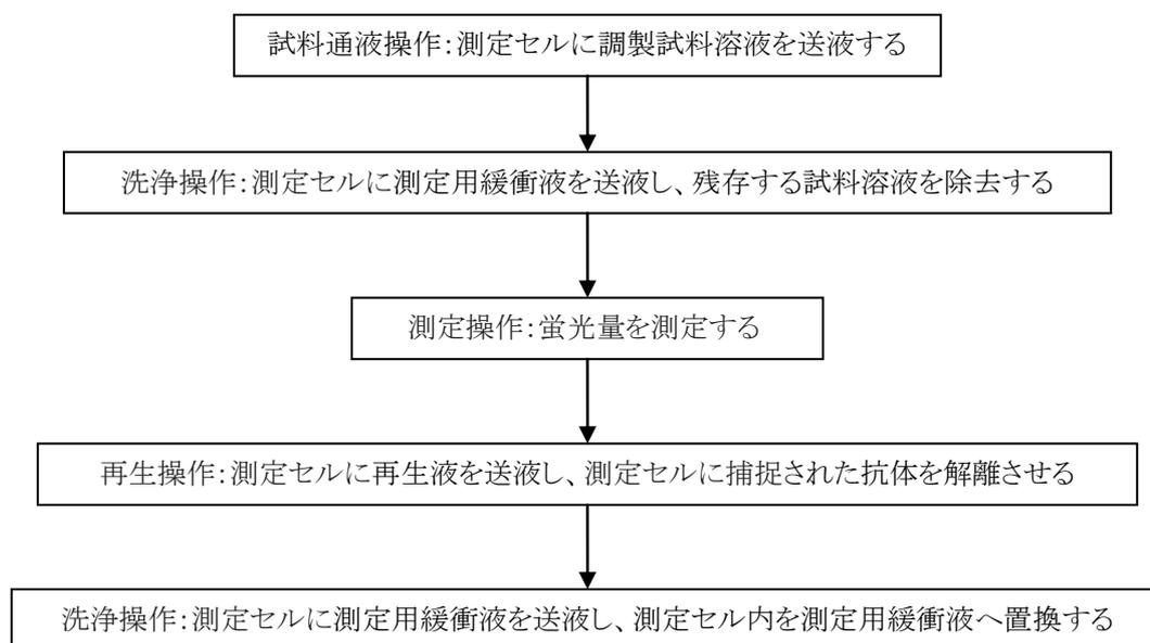
図 3.3.3.4 試料溶液測定のプロフロー
